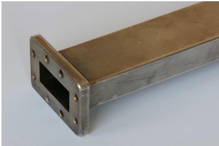
Abbildung 3.1.: Rechteckhohlleiter WR 137 mit Verbindungsflansch CMR 137. Breite  $a = 34,85$  mm und Höhe  $b = 15,80$  mm. Frequenzbereich 5,85 GHz – 8,20 GHz
