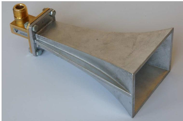
Abbildung 5.7.: Hornantenne für das X-Band (8,2 GHz – 12,4 GHz). Trichterförmig aufgeweiteter Hohlleiter WR 90. Weiterhin links sichtbar ein Übergang von Koaxialleitung auf Hohlleiter
