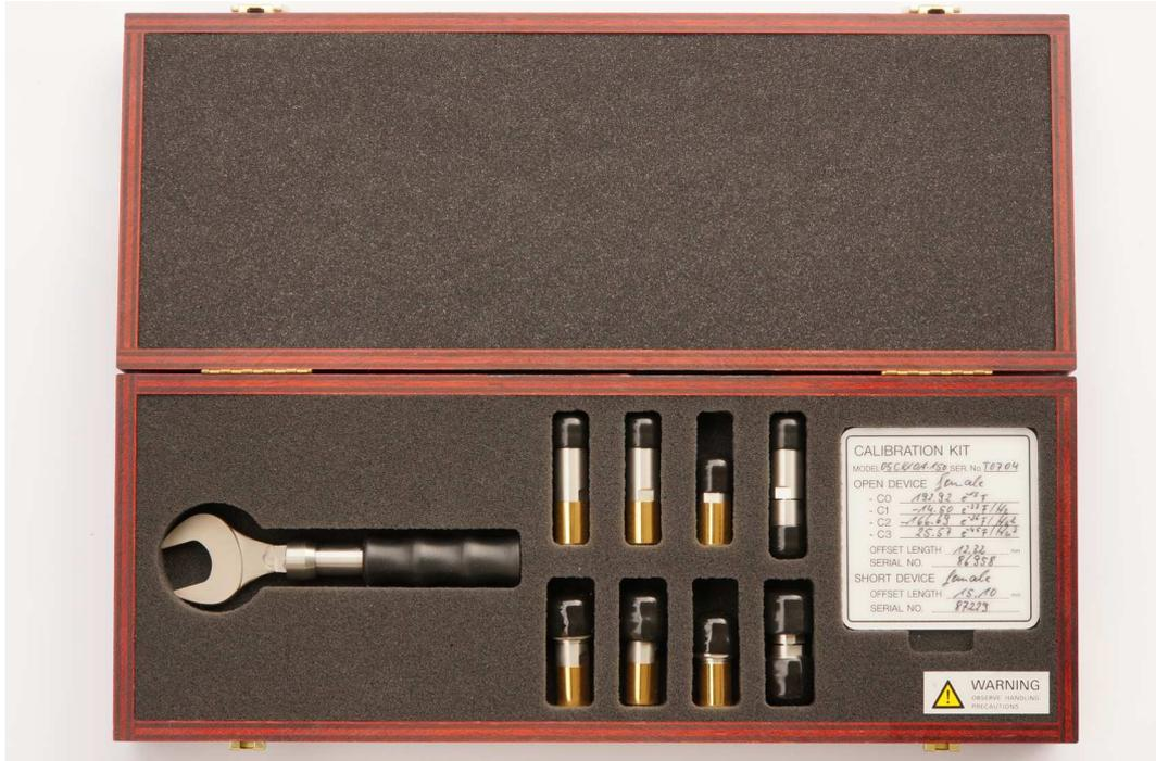
Abbildung 11.3.: Kalibrierkit bestehend aus Leerlauf, Kurzschluss, Abschluss und Durchverbindung jeweils als Buchse und als Stecker und einem Drehmomentschlüssel zum definierten Anziehen der Steckverbinder
