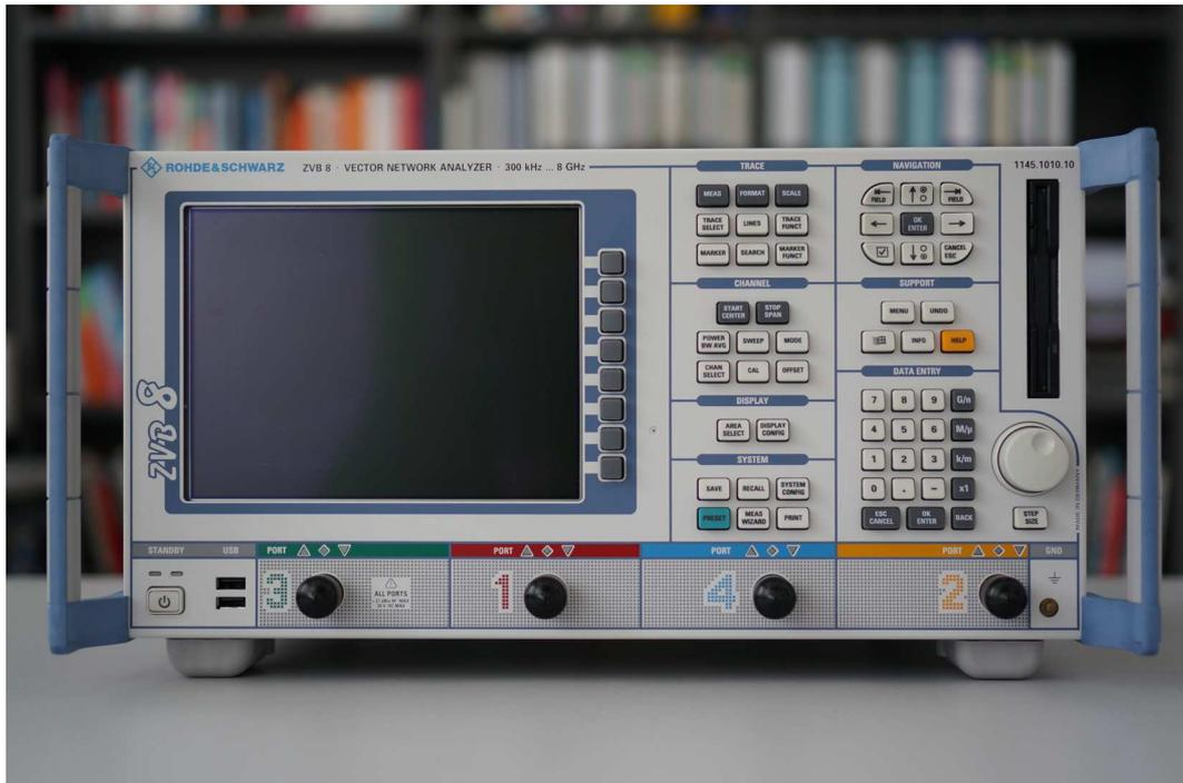
Abbildung 11.5.: Vektornetzwerkanalysator mit vier Messtoren
