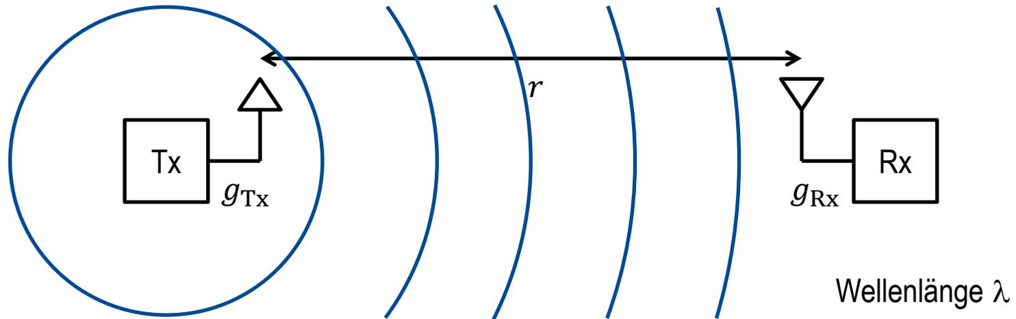
$$\text{Funkfeldgewinn: } g = \frac{P_{\text{RX}}}{P_{\text{TX}}} = \left( \frac{\lambda}{4\pi r} \right)^2 \underbrace{g_{\text{TX}} g_{\text{RX}}}_{\text{Antennengewinne}}$$
