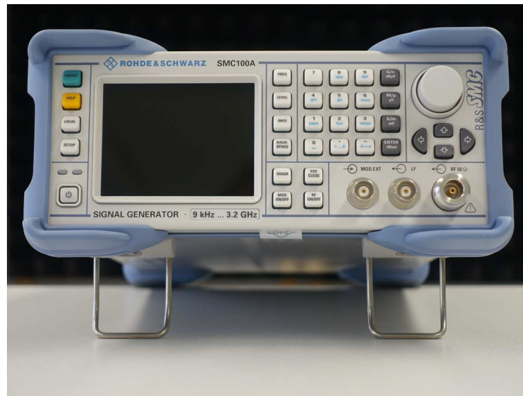
Abbildung 7: Signalgenerator SMC100A von Rohde & Schwarz
