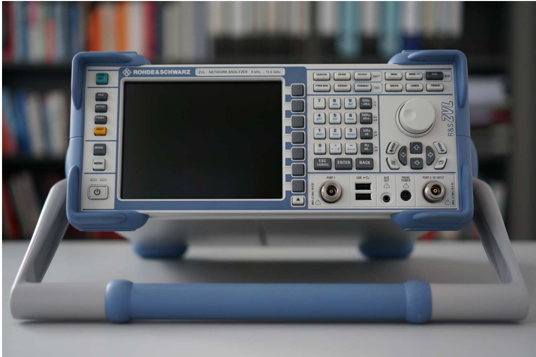
Abbildung 1: Vektornetzwerkanalysator ZVL von Rohde & Schwarz mit zwei Messtoren
