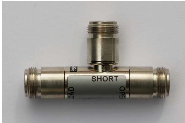
Abbildung 4: Kalibrierkit 53K34R-MSO3 von Rosenberger bestehend aus Leerlauf, Kurzschluss und Abschluss in kompakter Bauform
